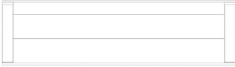
RP1 PANNEAU DE FAÎTE DE TOIT - W2A03795 (x2) 1 5/8"x13 3/8"x48 7/8" (42x341x1241)
