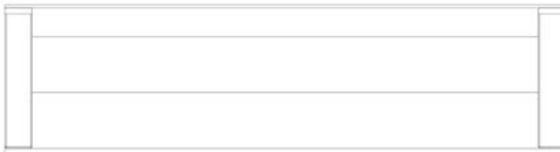
RP1 PANNEAU DE FAÎTE DE TOIT - W2A03795 (x2) 1 5/8"x13 3/8"x48 7/8" (42x341x1241)
