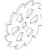
S02 SPROCKET - A4M02147 (x1) 3/16"x4 11/16"x4 11/16" (4x119x119)
