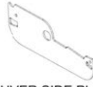
L03 LOUVER SIDE PLATE - A4M02334 (x66) 1/16"x2 3/16"x6 9/16" (2x55x167)
