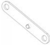
F03 LINKAGE STRAP - A4M02229 (x2) 1/2"x11/16"x3 13/16" (13x17x97)
