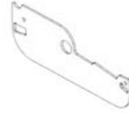
L03 PLAQUE LATÉRALE DE PERSIENNE -A4M02334 (x64) 1/16"x2 3/16"x6 9/16" (2x55x167)
