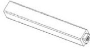
F05 PORTE-CLÉS - A4M02226 (x2) 1/2"x1/2"x3 3/4" (13x13x95)
