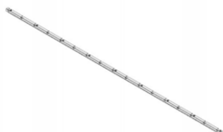
M01 BÂTI À PERSIENNES - A4M02595 (x1) 1 "x1 15/16"x110 3/4" (25x49x2813)
