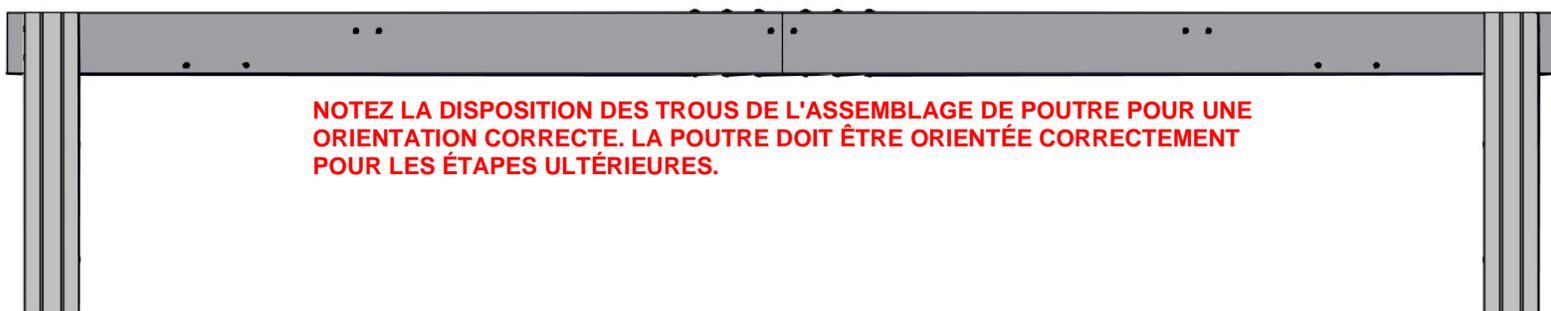
**NOTEZ LA DISPOSITION DES TROUS DE L'ASSEMBLAGE DE POUTRE POUR UNE ORIENTATION CORRECTE. LA POUTRE DOIT ÊTRE ORIENTÉE CORRECTEMENT POUR LES ÉTAPES ULTÉRIEURES.**
