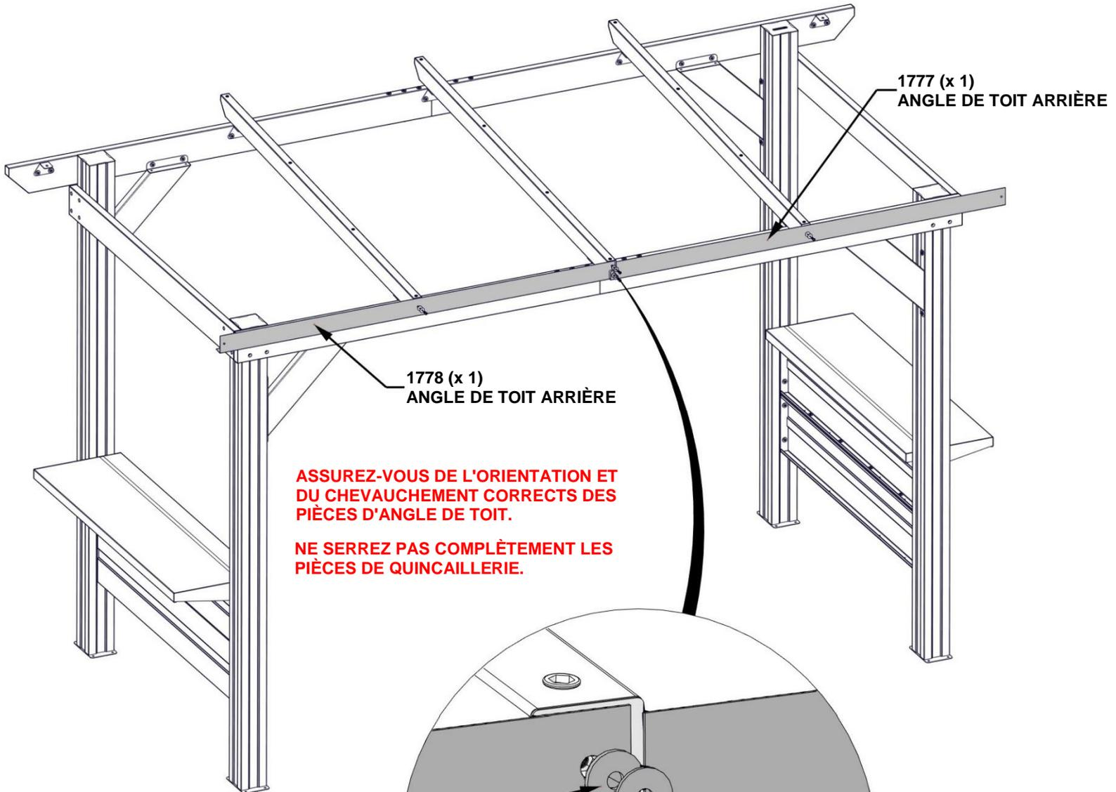
**ASSUREZ-VOUS DE L'ORIENTATION ET DU CHEVAUCHEMENT CORRECTS DES PIÈCES D'ANGLE DE TOIT.**
