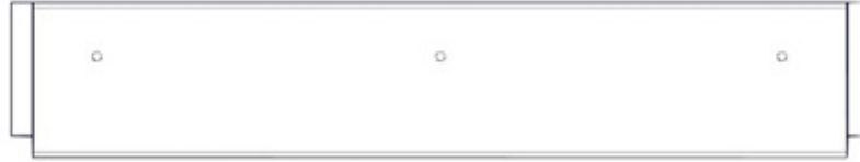
E17 FAN FRAME - W4L20614 (x1) 1 7/16"x3 3/8"x18 11/16" (36x86x475)
