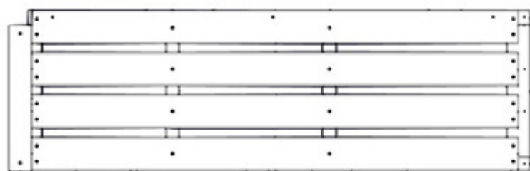
TB01 ASSEMBLAGE DE TABLE - W2A04439 (x1) 2 1/16"x16 1/16"x51 15/16" (52x408x1319)
