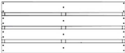
SH01 ASSEMBLAGE D'ÉTAGÈRE - W2A04437 (x1) 3"x15 7/8"x37 13/16" (76x404x960)
