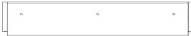
E17 CHARPENTE À BOUCHE - W4L20614 (x1) 1 7/16"x3 3/8"x18 11/16" (36x86x475)
