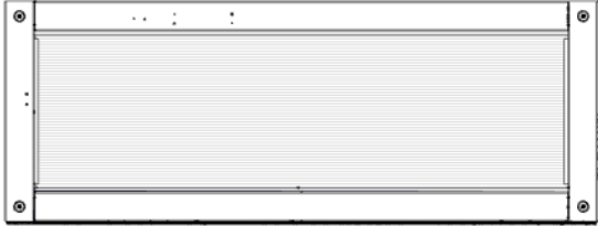
WA01 ASSEMBLAGE DE FENÊTRE - W2A04438 (x1) 1 7/8"x17 1/2"x47 3/16" (48x444x1198)
