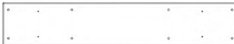
OV01 ENTRETOISE DE PROTECTION DU RÉCHAUFFEUR - W4L21887 (x2) 1 3/16"x4 7/16"x23 15/16" (30x112x608)
