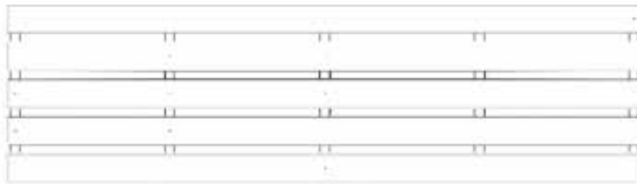
FP01 - ENSEMBLE DE PANNEAUX DE PLANCHER W2A04829 (x1) 1 15/16 po x 20 7/8 po x 73 7/8 po (50 x 530 x 1876)
