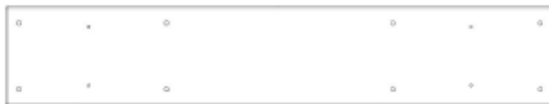
OV01 ENTRETOISE DE PROTECTION DU RÉCHAUFFEUR - W4L21B87 (x2) 1 3/16 po x 4 7/16 po x 23 15/16 po (30 x 112 x 608)
