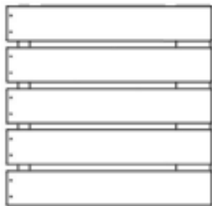
BA03 ASSEMBLAGE DE BANC EXTÉRIEUR - W2A04806 (x1) 1 15/16 po x 19 1/8 po x 19 3/4 po (50 x 486 x 502)
