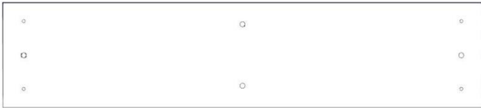
Y01 PLANCHE DE PROTECTION DU CHAUFFE-SAUNA - W4L22601 (x2) 5/8 po x 4 po x 18 1/4 po (16 x 102 x 464)
