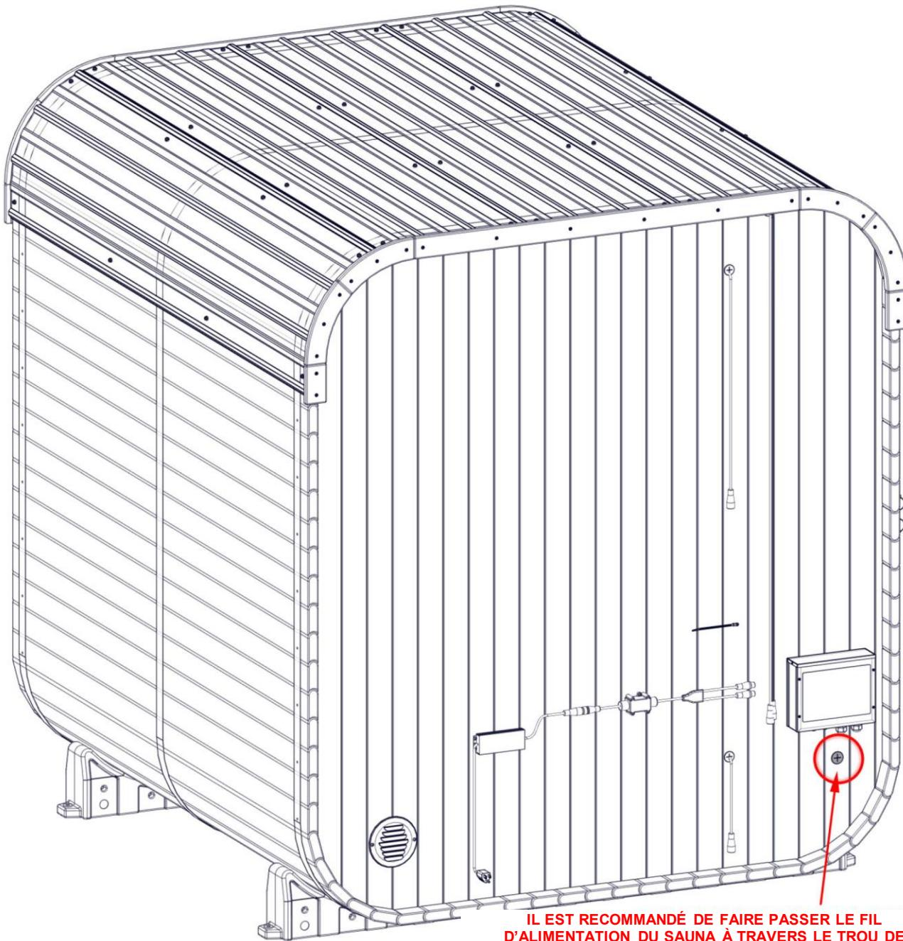
IL EST RECOMMANDÉ DE FAIRE PASSER LE FIL D'ALIMENTATION DU SAUNA À TRAVERS LE TROU DE L'EXTÉRIEUR VERS L'INTÉRIEUR DU SAUNA, PUIS DE FIXER L'EXTRÉMITÉ DU FIL D'ALIMENTATION DU SAUNA PRÈS DU CHAUFFE-SAUNA À L'AIDE D'ATTACHES AUTOBLOQUANTES. CELA ÉVITE LES INTERFÉRENCES AVEC LES SIÈGES DE BANC.
