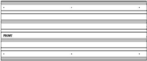
3113 TÔLE D'ACIER 29GA - A4M03113 (x2) 1/4 po x 18 7/8 po x 46 7/16 po (7 x 480 x 1179)
