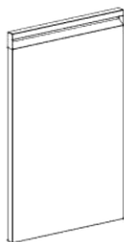
D3 (x1) ASSEMBLAGE DU PANNEAU DU TIROIR - A4M05464 22 7/16 po x 15 1/8 po x 7/8 po (22 x 384 x 570)
