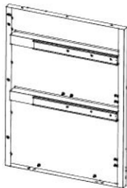
S5 ASSEMBLAGE DU PANNEAU LATÉRAL- A4M05460 (x1) 33 3/4 po x 25 po x 1 3/8 po (35 x 635,0 x 857)
