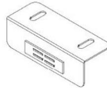
A2 SUPPORT D'AIMANT - A4M03026 (x6) 1 po x 1 1/4 po x 3 1/8 po (25 x 31 x 80)
