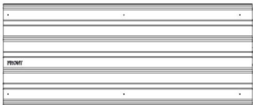
3113 TÔLE D'ACIER 29GA - A4M03113 (x3) 1/4 po x 18 7/8 po x 46 7/16 po (7 x 480 x 1179)
