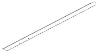
5505 BORD D'ÉGOUTTEMENT - A4M05505 (x1) 3/16 po x 3 7/16 po x 78 1/4 po (6 x 88 x 1987)
