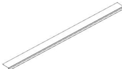
3114 BORD D'ÉGOUTTEMENT - A4M03114 (x2) 7/16 po x 3 1/8 po x 46 1/4 po (11 x 79 x 1175)
