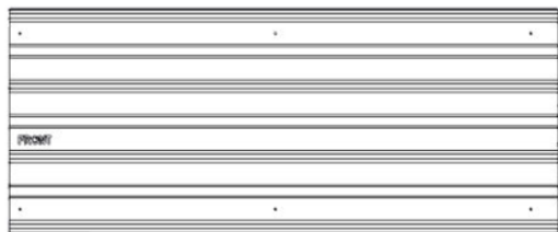
TÔLE D'ACIER 29GA - A4M03113 (x3) 1/4 po x 18 7/8 po x 46 7/16 po (7 x 480 x 1179)
