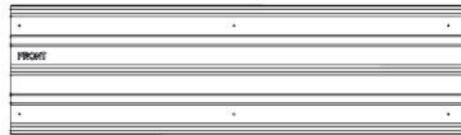
5500 TÔLE D'ACIER 29GA - A4M05500 (x1) 1/4 po x 13 po x 46 7/16 po (7 x 330 x 1179)
