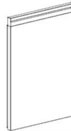
D6 ASSEMBLAGE DE LA PORTE - A4M05471 (x1) 22 3/8 po x 15 1/2 po x 7/8 po (22 x 393,5 x 569)
