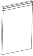
D1 ASSEMBLAGE DE PORTE - A4M05487 (x1) 22 3/8 po x 18 7/8 po x 7/8 po (22 x 480 x 568)
