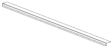
5504 BORD D'ÉGOUTTEMENT - A4M05504 (x2) 1 1/2 po x 3 5/16 po x 76 11/16 po (0,5 x 84 x 1948)
