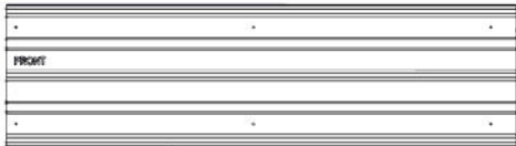
5500 29GA STEEL SHEETING - A4M05500 (x1) 1/4"x13"x46 7/16" (7x330x1179)
