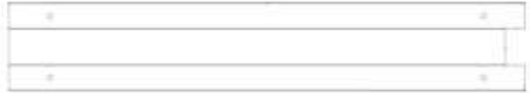
OG12 PLANCHE À GOULOTTE - W4L22389 (x1) 1 3/16 po x 3 3/8 po x 19 3/4 po (30 x 86 x 501)
