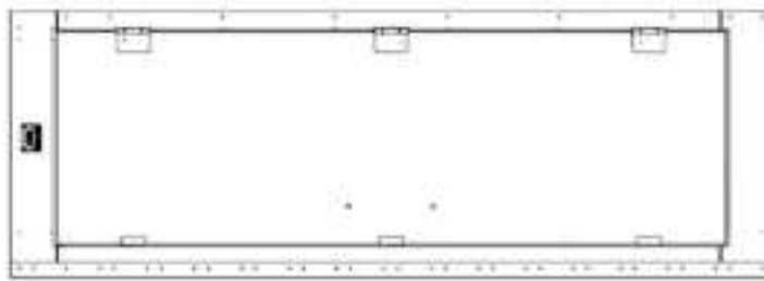
WP01 ASSEMBLAGE DU PANNEAU MURAL DE LA PORTE - W2A05246 (x1) 2 3/8"x27 1/4"x77 5/8" (60x692x1972)
