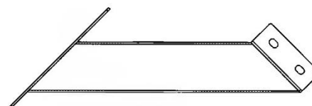
F3 | CALE ANGULAIRE COURTE - A4M01275 (2) | 1 1/8 po x 4 po x 14 po (30x101x355)
