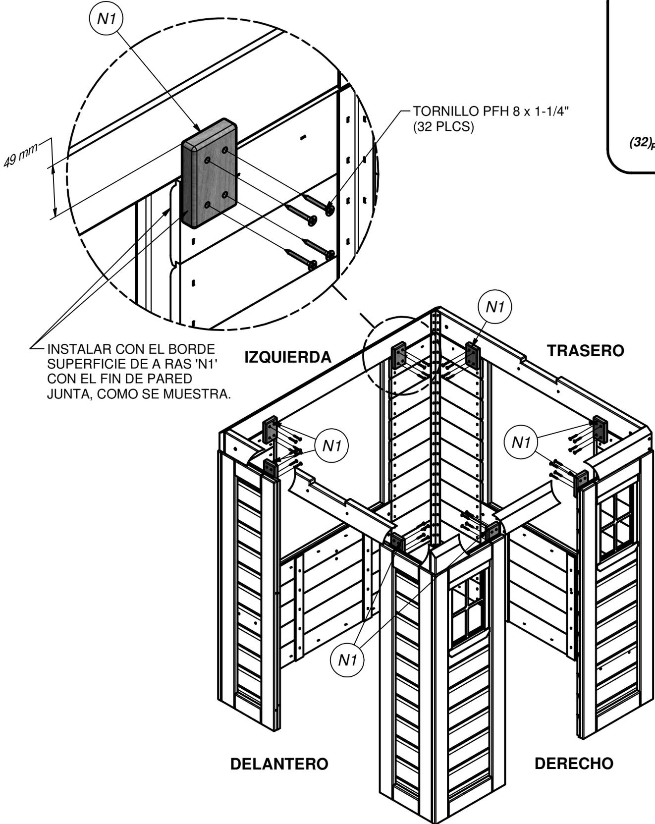
INSTALAR CON EL BORDE SUPERFICIE DE A RAS 'N1' CON EL FIN DE PARED JUNTA, COMO SE MUESTRA.
