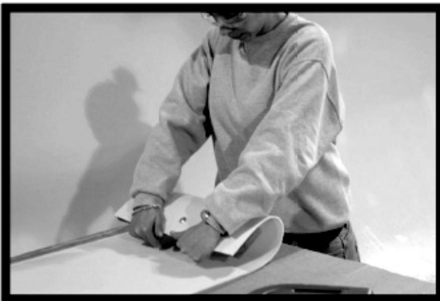
**USO EL REFUERZO LA RESBALADILLA 'M70' COMO PLANTILLA. PARA PERFORAR EL AGUJERO INFERIOR EN EL LECHO LA RESBALADILLA. COLOQUE EL REFUERZO LA RESBALADILLA A 1/2" (12 mm) HACIA ARRIBA DEL BORDE INFERIOR DEL LECHO LA RESBALADILLA ANTES DE MARCAR EL PATRÓN DEL AGUJERO. UTILICE UNA BROCA DE 7/16" (11 mm) PARA PATRÓN DEL AGUJERO.**
