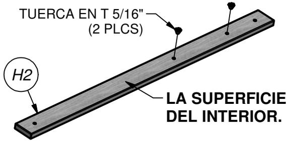
ARMAR TUERCAS EN T EN LA PLACA ANTES DE LA INSTALACIÓN.
