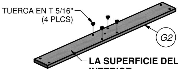
ARMAR TUERCAS EN T EN LA PLACA ANTES DE LA INSTALACIÓN.
