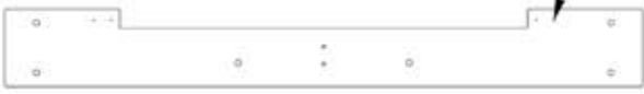
G11 Tablero de Pared del Lado Izquierdo - W4L17651 (x1) 1"x5 1/4"x42 1/2" (24x134x1080)
