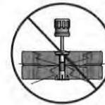
Cette icône vous met en garde contre le serrage excessif de vos boulons. Cela permet d'éviter les dommages structurels ainsi que l'éclatement du bois.
