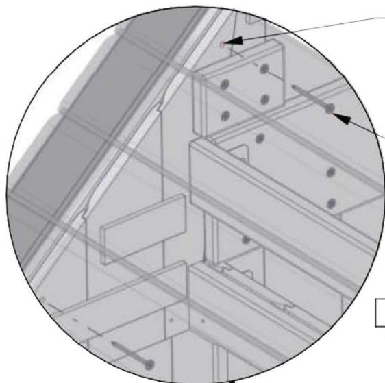
REMARQUEZ QUE LES TROUS PRÉ-PERCÉS DANS LES PANNEAUX LATÉRAUX DOIVENT ÊTRE ALIGNÉS AVEC LES TROUS TRAVERSANTS DES PANNEAUX DE TOIT. RÉPÉTEZ CE RACCORD À CHAQUE EXTRÉMITÉ DU PANNEAU DE TOIT.
