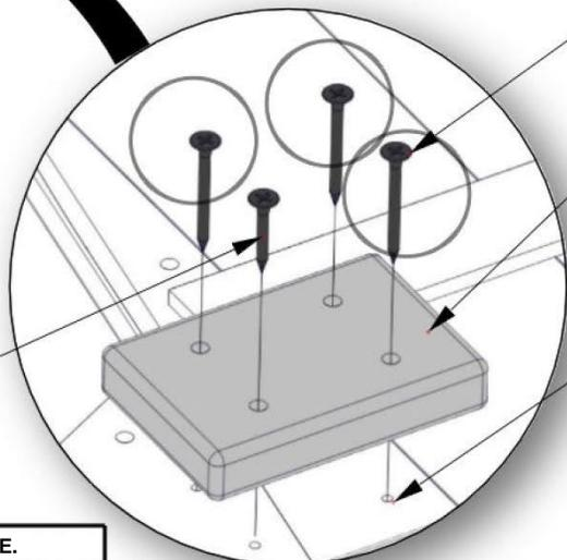
ALIGNER AVEC LES AVANT-TRous PRÉ-PERCÉS DANS LES PANNEAUX.
