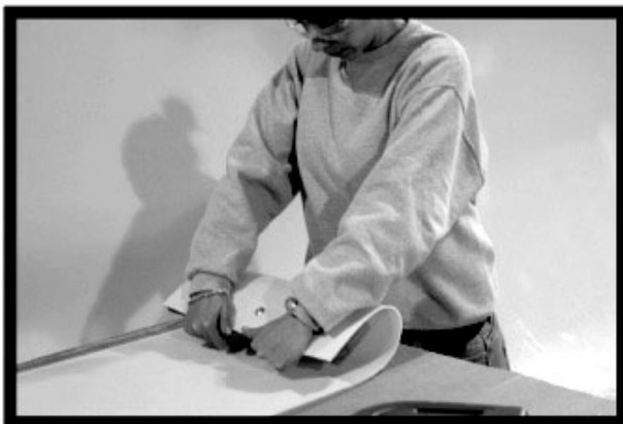
VERWENDEN SIE DIE M70 RUTSCHBETT STÜTZE ALS EINE VORLAGE, UM DAS UNTERE LOCHMUSTER IN DAS RUTSCHBETT ZU BOHREN. STELLEN SIE SICHER, DIE RUTSCHWINKEL 1/2" VOR DIE UNTEREN ECKE DES RUTSCHBETTES ZU SETZEN, BEVOR SIE EIN LOCHMUSTER BOHREN. VERWENDEN SIE EINEN 3/8" BOHRAUFSATZ, UM DAS LOCHMUSTER ZU BOHREN.
