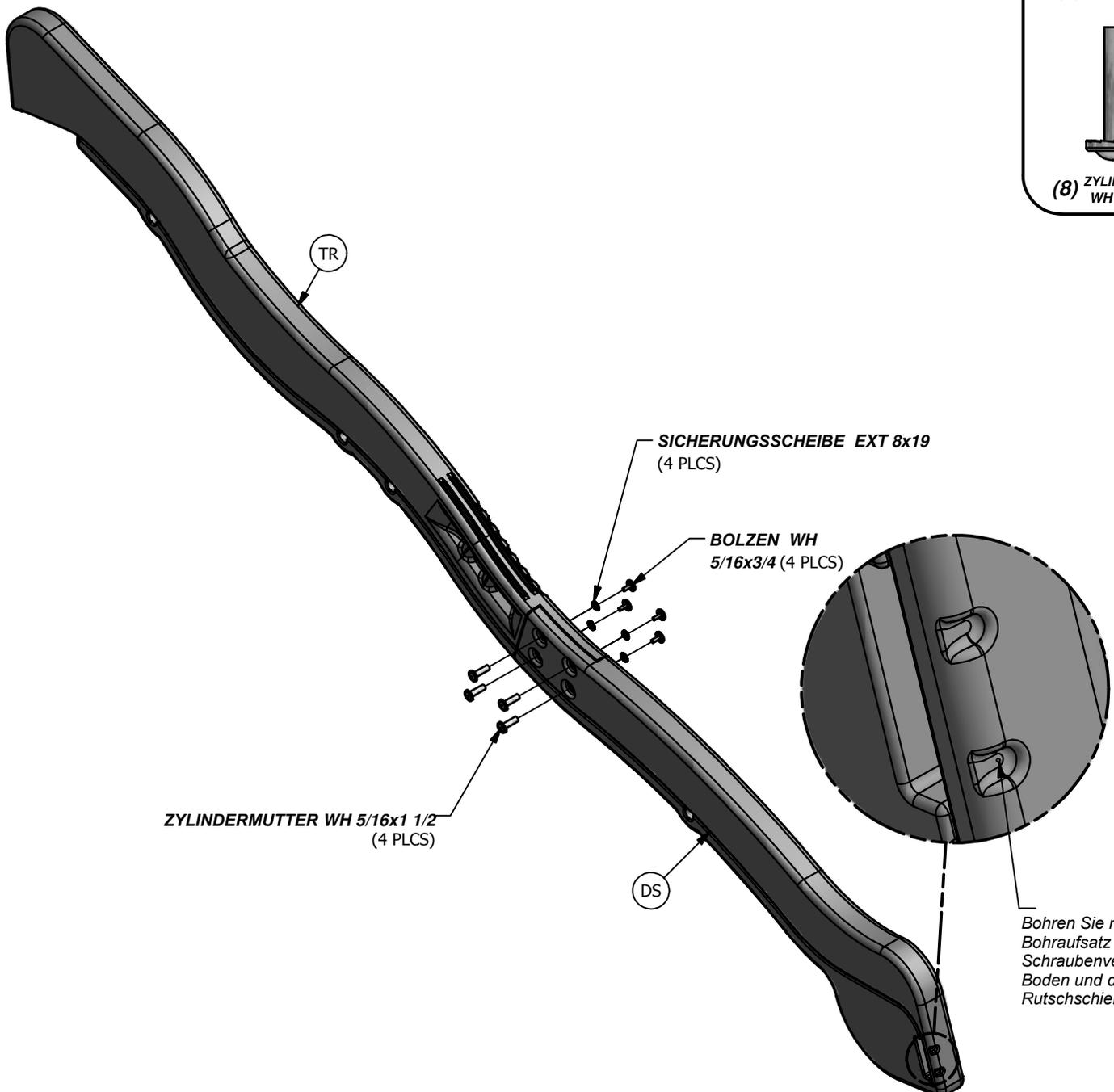
Bohren Sie mit einem 1/8" Bohraufsatz Pilotbohrer alle Schraubenvertiefungen am Boden und den Seiten der Rutschschiene.
