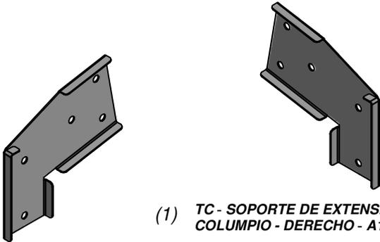
(1) **TC - SOPORTE DE EXTENSIÓN DE LA VIGA DEL COLUMPIO - DERECHO - A100326**
