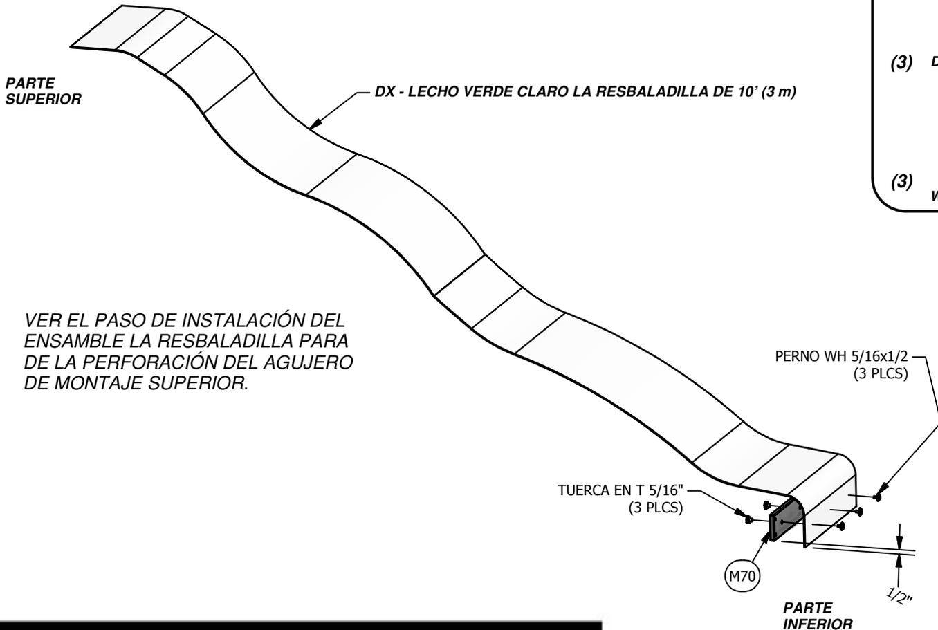
VER EL PASO DE INSTALACIÓN DEL ENSAMBLE LA RESBALADILLA PARA DE LA PERFORACIÓN DEL AGUJERO DE MONTAJE SUPERIOR.
