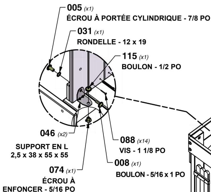
**EN UTILISANT LE SUPPORT EN L COMME GUIDE, PERCEZ (2) TROUS DE 3/8 po [10 mm] À TRAVERS LE PLANCHER POUR LA QUINCAILLERIE**
