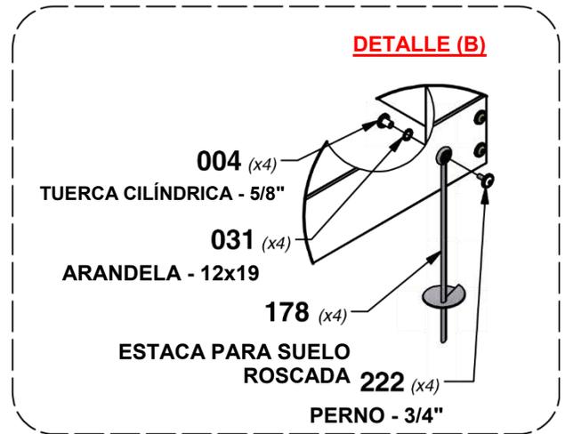
**INSERTE LAS ESTACAS (527) EN EL SUELO EN LAS UBICACIONES INDICADAS. UTILIZANDO LAS ESTACAS COMO GUÍA, PERFORE UN ORIFICIO DE 7/16" [10 mm] PARA COLOCAR LAS PIEZAS METÁLICAS.**
