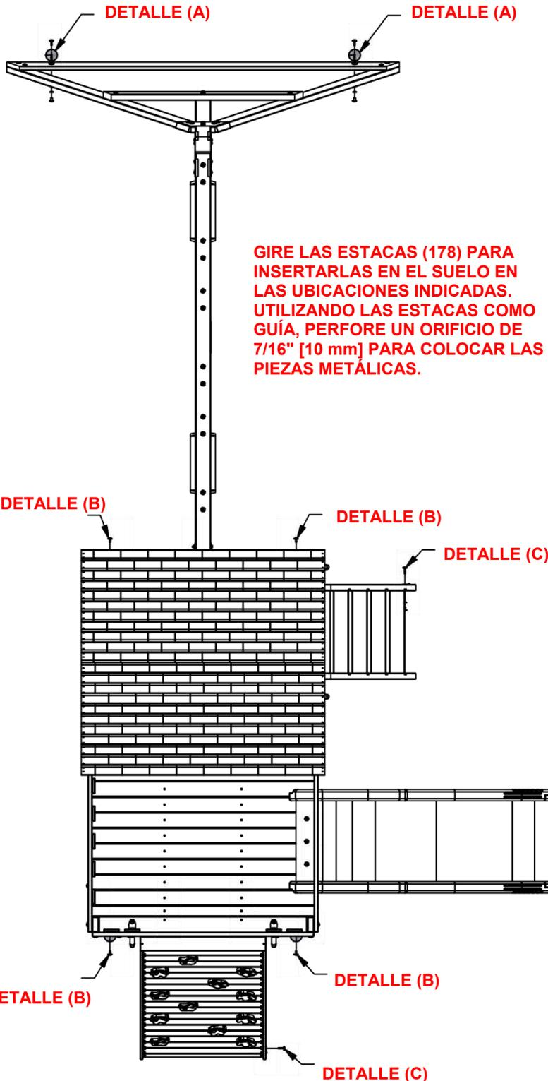
**GIRE LAS ESTACAS (178) PARA INSERTARLAS EN EL SUELO EN LAS UBICACIONES INDICADAS. UTILIZANDO LAS ESTACAS COMO GUÍA, PERFORE UN ORIFICIO DE 7/16" [10 mm] PARA COLOCAR LAS PIEZAS METÁLICAS.**
