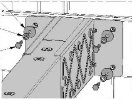
ASSEMBLAGE DE LA POUTRE DE LA BALANÇOIRE
