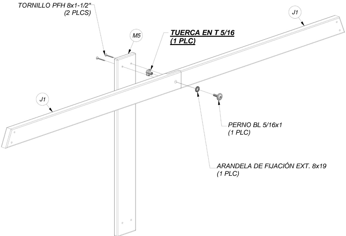
**MONTAJE DE GUÍA DE COLUMPIO DE SEGURIDAD**
