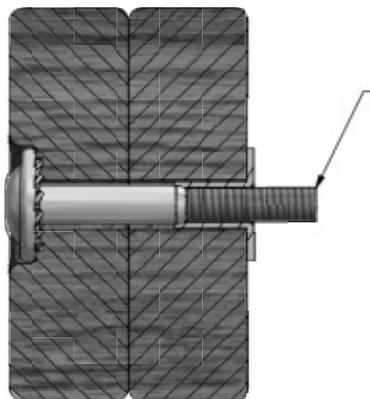
Si vous pouvez voir le filetage et que votre boulon dépasse de l'écrou encastré, il est possible que vous ayez trop serré le boulon ou utilisé du matériel incorrect. Si vous avez trop serré, retirez le boulon et ajoutez des rondelles pour éliminer la saillie.
