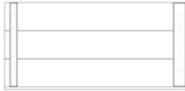
RP5 | PANEL DEL TECHO DEL PORCHE (1) | DERECHO - W2A02654 1 5/8"x15 5/8"x32 7/8" (42x396x834)
