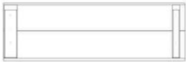
RP1 | PANEL SUPERIOR DEL TECHO DEL PORCHE IZQUIERDO - W2A02650 (1) | 1 5/8"x10 1/2"x32 7/8" (42x268x834)
