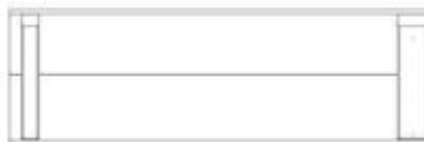
RP4 | PANEL SUPERIOR DEL TECHO DEL PORCHE DERECHO - W2A02653 (1) 1 5/8"x10 1/2"x32 7/8" (42x268x834)
