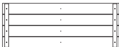
FP1 | PANNEAU DE PLANCHER INFÉRIEUR - W2A02648 (4) | 1 5/8"x13 1/2"x35 3/8" (40x344x897)
