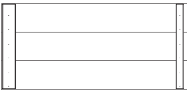
RP2 | PANNEAU TOIT PORCHE GAUCHE - W2A02651 (1) 1 5/8"x15 5/8"x32 7/8" (42x396x834)
