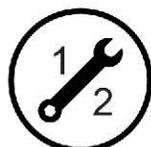
Das Symbol zeigt die Größe eines Gabelschlüssels an. Verwendung des Schlüssels als Bruchstrich.
