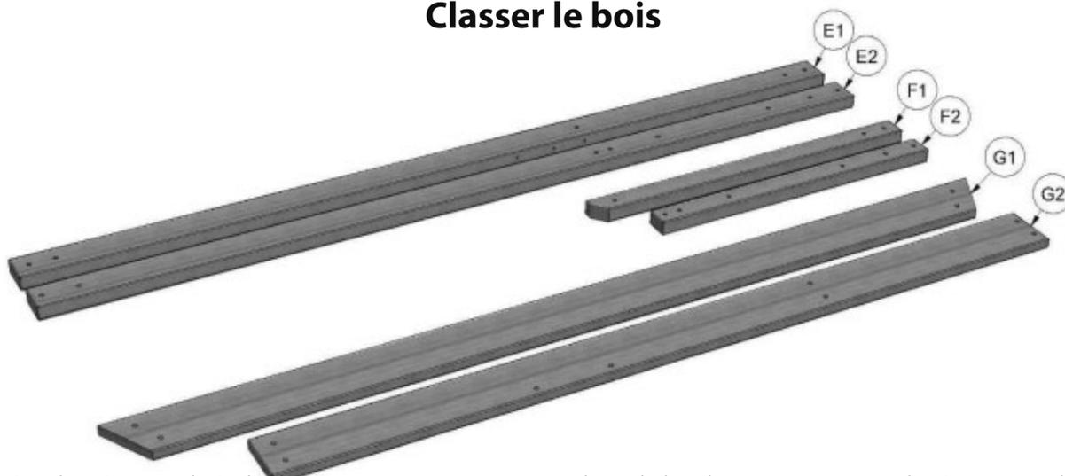
Lorsque vous retirez les pièces en bois des boîtes, nous vous recommandons de les classer par numéro de pièce avant de commencer le montage. Cela permettra un montage plus rapide et une identification facile de toutes les pièces manquantes ou endommagées.
