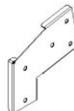
A100326 | SOPORTE DE EXTENSIÓN (x1) | DE VIGA DEL COLUMPIO-DERECHA
