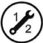
L'icône montre la taille d'une clé ouverte. Utilisez la clé comme barre de fraction.
