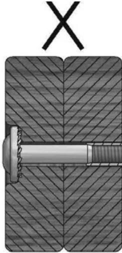
Si vous voyez des filetages exposés et que votre boulon dépasse au-delà de l'écrou encastré, vous avez peut-être trop serré le boulon ou utilisé du matériel incorrect. Si vous avez trop serré, retirez le boulon et ajoutez des rondelles pour éliminer la saillie.
