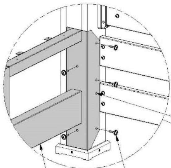
(1) BRAZO METÁLICO SUBMONTAJE - IZQUIERDA
