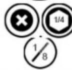
Cette icône vous montrera quels éléments de forage sont nécessaires. Pour cet exemple, vous aurez besoin d'un tournevis à tête cruciforme, d'un tournevis 1/4 et d'un foret 1/8.
