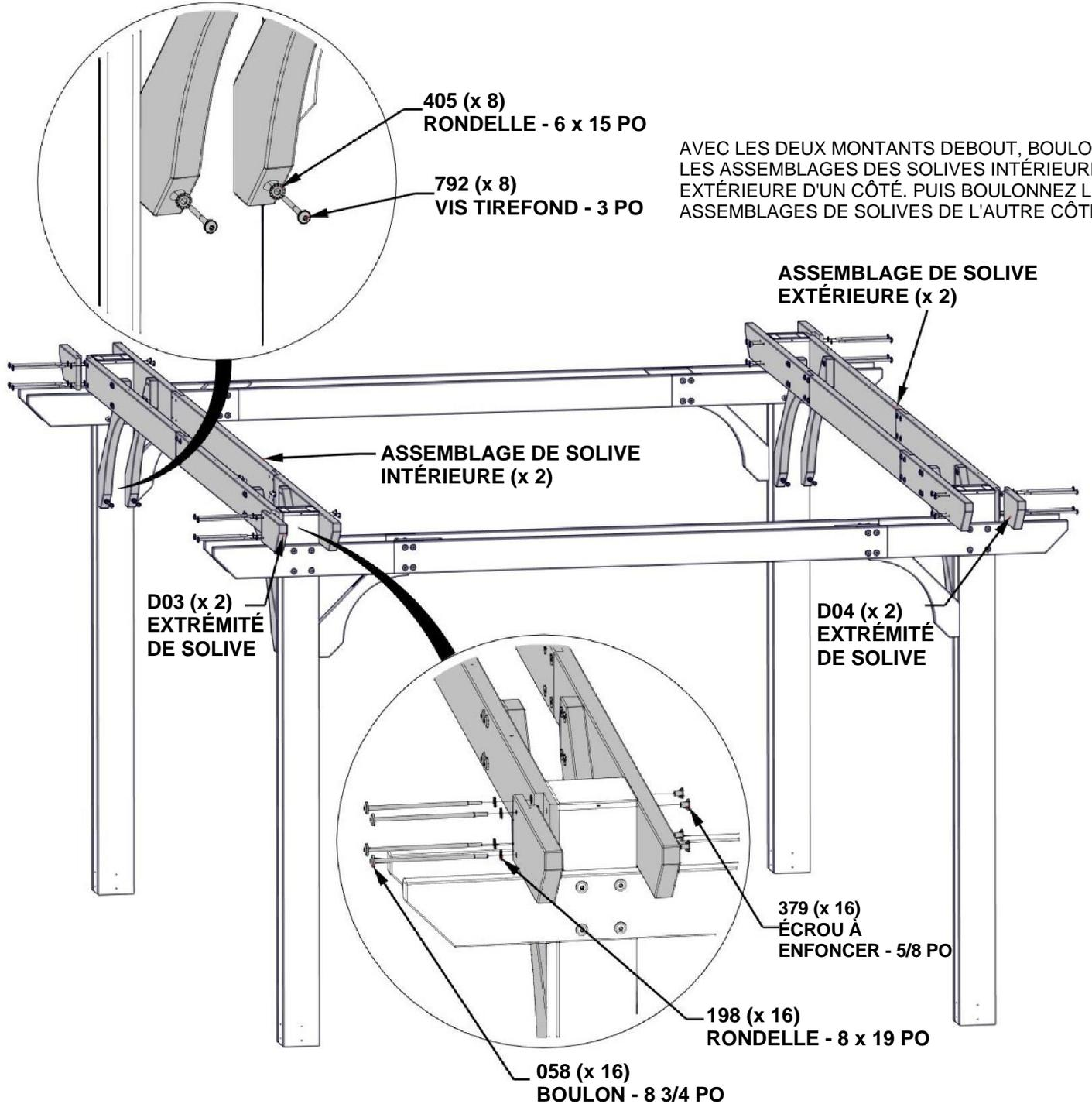
AVEC LES DEUX MONTANTS DEBOUT, BOULONNEZ LES ASSEMBLAGES DES SOLIVES INTÉRIEURE ET EXTÉRIEURE D'UN CÔTÉ. PUIS BOULONNEZ LES ASSEMBLAGES DE SOLIVES DE L'AUTRE CÔTÉ.
