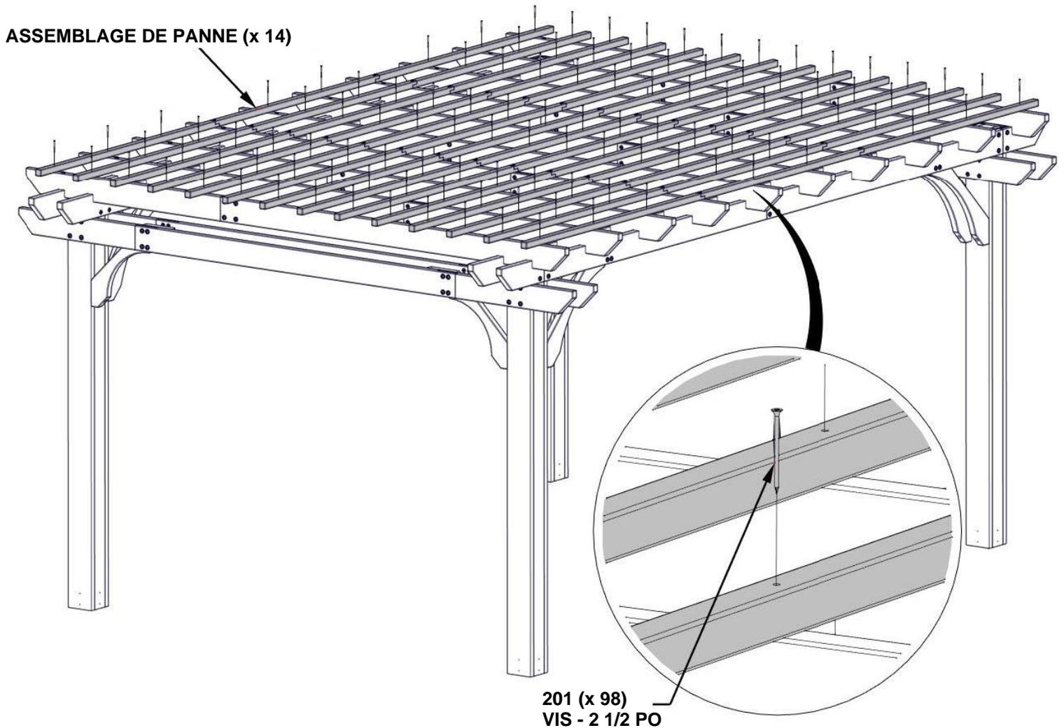
**FIXEZ LES ASSEMBLAGES DE PANNES À L'AIDE DES AVANT-TROUS DES ASSEMBLAGES DE SOLIVES À FENTE.**
