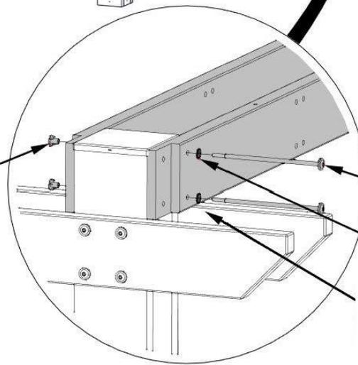
INSERTE LOS PERNOS CON LAS ARANDELAS PARA SOSTENER EL MONTAJE EN POSICIÓN HASTA QUE LAS VIGUETAS INTERIORES ESTÉN FIJADAS, LUEGO AJUSTE LOS PERNOS CON LAS TUERCAS EN T.
