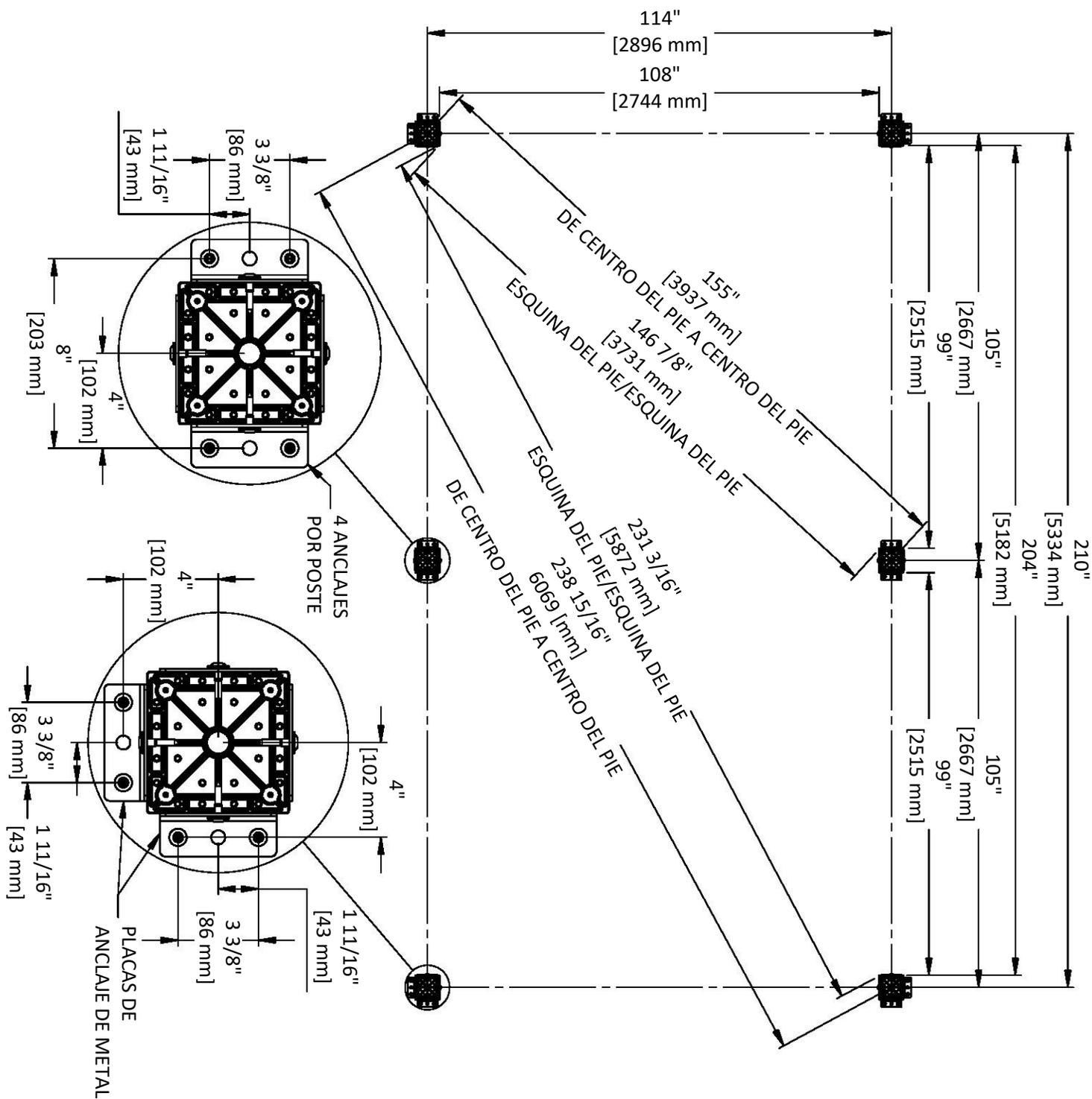
NOTA: LAS DIMENSIONES SON PARA LAS PLACAS DE ANCLAJE SE MONTA A LOS POSTES EXCEPTO DONDE SE INDIQUE
