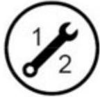
Cette icône montre la taille d'une clé à tuyauter. Utilisez la clé comme barre de fraction.
