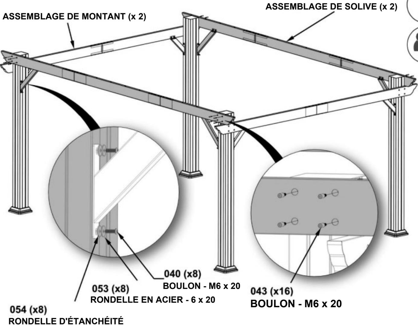
ÉQUERREZ TOUS LES POTEAUX SUR LES ASSEMBLAGES DES SOLIVES ET SERREZ COMPLÈTEMENT TOUS LES BOULONS.
