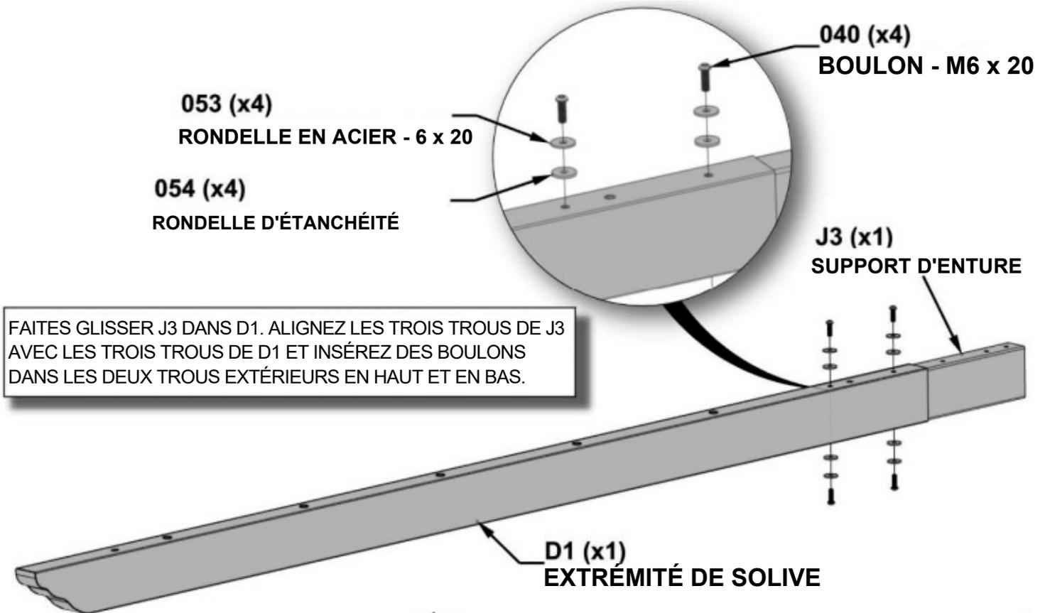
FAITES GLISSER J3 DANS D1. ALIGNEZ LES TROIS TROUS DE J3 AVEC LES TROIS TROUS DE D1 ET INSÉREZ DES BOULONS DANS LES DEUX TROUS EXTÉRIEURS EN HAUT ET EN BAS.
