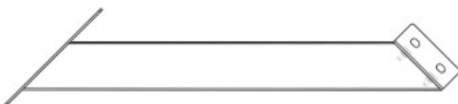
F1 | LONG ANGLE BRACE - A4M01273 (2) 1\frac{1}{8} \times 4 \times 21\frac{1}{2} (30x101x546)
