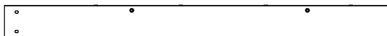
C2 | EXTRÉMITÉ DE SOLIVE - A4M01445 (x2) | 1 3/8 po x 5 1/4 po x 62 1/2 po (36 x 134 x 1587)
