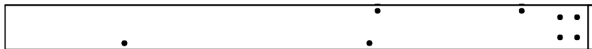
B1 | EXTRÉMITÉ DE SOLIVE - A4M01441 (x2) | 1 3/8 po X 5 1/4 po X 68 5/8 po (36 x 134 x 1743)
