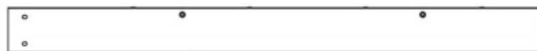
C2 (x2) | EXTRÉMITÉ DE SOLIVE - A4M0144 1 3/8 po x 5 1/4 po x 62 1/2 po (36 x 134 x 1587)
