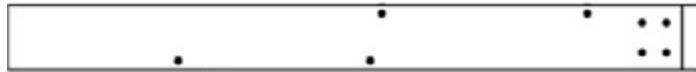
B1 (x2) | EXTRÉMITÉ DE SOLIVE - A4M01461 1 3/8 po X 5 1/4 po X 49 3/4 po (36 x 134 x 1264)
