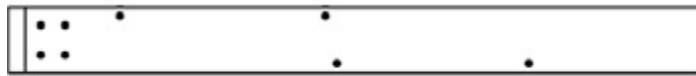
B2 (x2) | EXTRÉMITÉ DE SOLIVE - A4M01462 1 3/8 po X 5 1/4 po X 49 3/4 po (36 x 134 x 1264)
