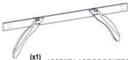
ASSEMBLAGE DE POUTRE DE 10 PIEDS
