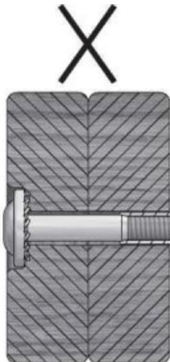
Si ve roscas expuestas y un perno que sobresale de una tuerca T, es posible que haya ajustado demasiado el perno o que haya utilizado una pieza metálica incorrecta. Si ha apretado demasiado la pieza, retire el perno y agregue arandelas para que la pieza deje de sobresalir.
