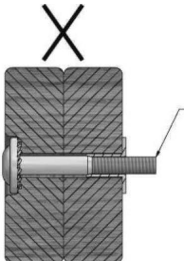
Si vous pouvez voir le filetage et que votre boulon dépasse de l'écrou encastré, il est possible que vous ayez trop serré le boulon ou utilisé du matériel incorrect. Si vous avez trop serré, retirez le boulon et ajoutez des rondelles pour éliminer la saillie.
