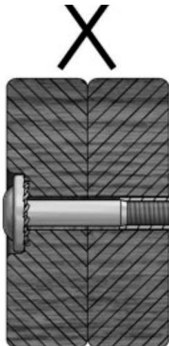
Si ve roscas expuestas y un perno que sobresale más allá de una tuerca en T, es posible que haya apretado demasiado el perno o que haya utilizado una pieza metálica incorrecta. Si ha apretado demasiado la pieza, retire el perno y agregue arandelas para que la pieza deje de sobresalir.
