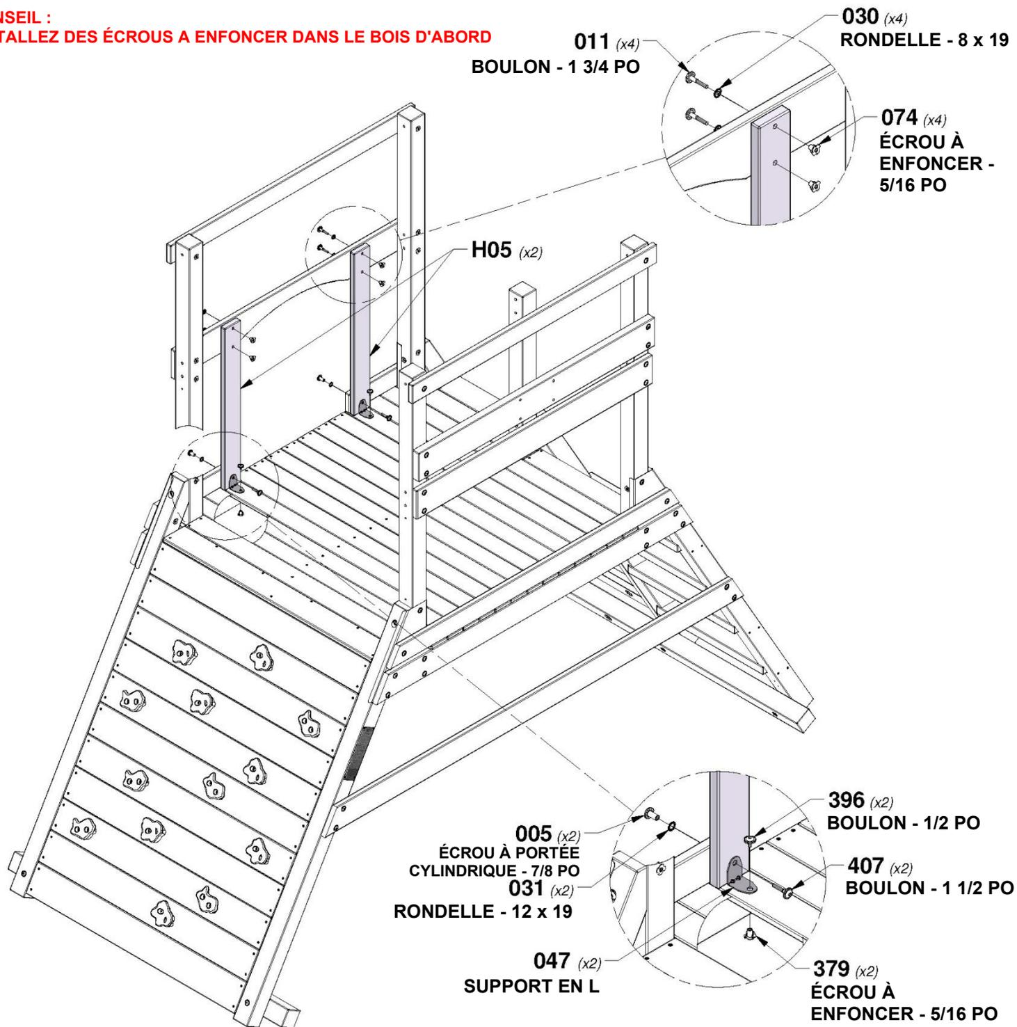
**EN UTILISANT LES SUPPORTS COMME GUIDE, PERCEZ (2) TROUS DE 3/8 po (10 mm) À TRAVERS LE PLANCHER POUR LA QUINCAILLERIE.**
