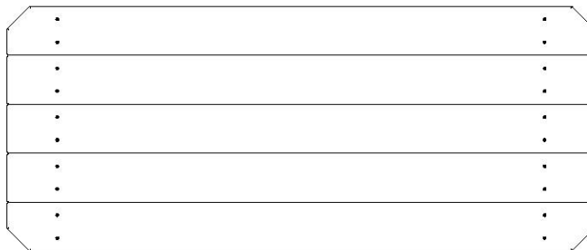
TP1 | TABLÓN DE LA MESA DE PICNIC - W2A03413 (x1) | 1 7/8"x16 15/16"x40 11/16" (48x430x1034)
