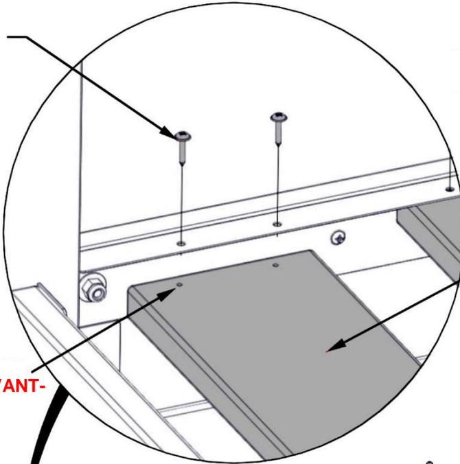
**ALIGNEZ LES AVANT-TRUS DES LATTES AVEC LES TROUS DU SUPPORT DE SOUTIEN. VISSEZ EN PLACE.**
