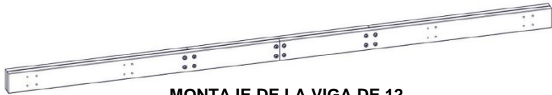
MONTAJE DE LA VIGA DE 12 PIES DE PASOS ANTERIORES
